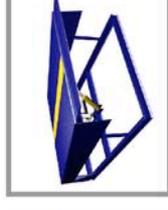
Электродвигательная уравнивательная платформа с выдвинутой телескопической аппаратурой.
