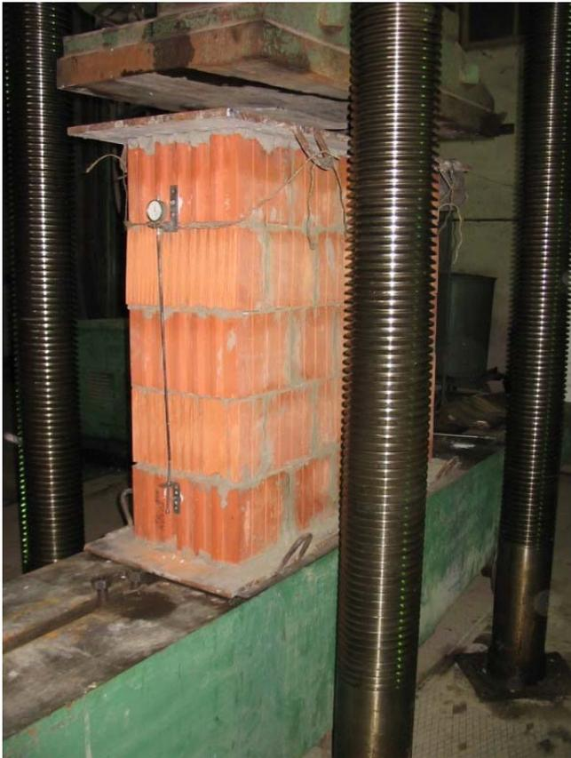
*Рис 2. Вид образца из крупноформатных поризованных камней в прессе, расстановка индикаторов на гранях кладки при центральном сжатии*
