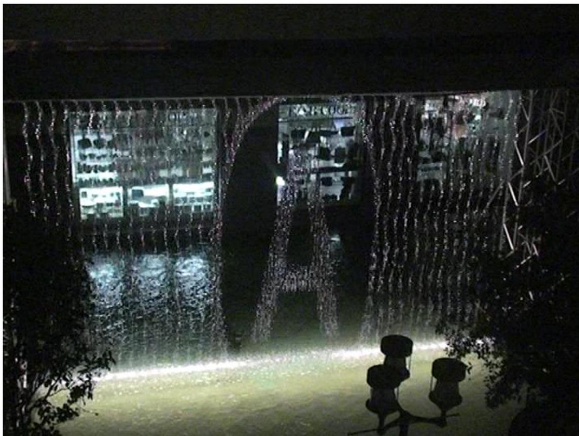
Принцип работы аквапроцессора фонтана пространственный принтер, основан на множестве уникальных управляемых форсунок. Вода, поступающая из резервуара через систему водоподготовки, на аквапроцессор подается по трубкам к управляемым форсункам.
